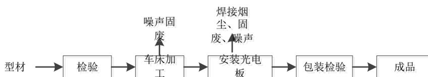
图 3.1-5 项目现有工程光电屋面工艺流程图
