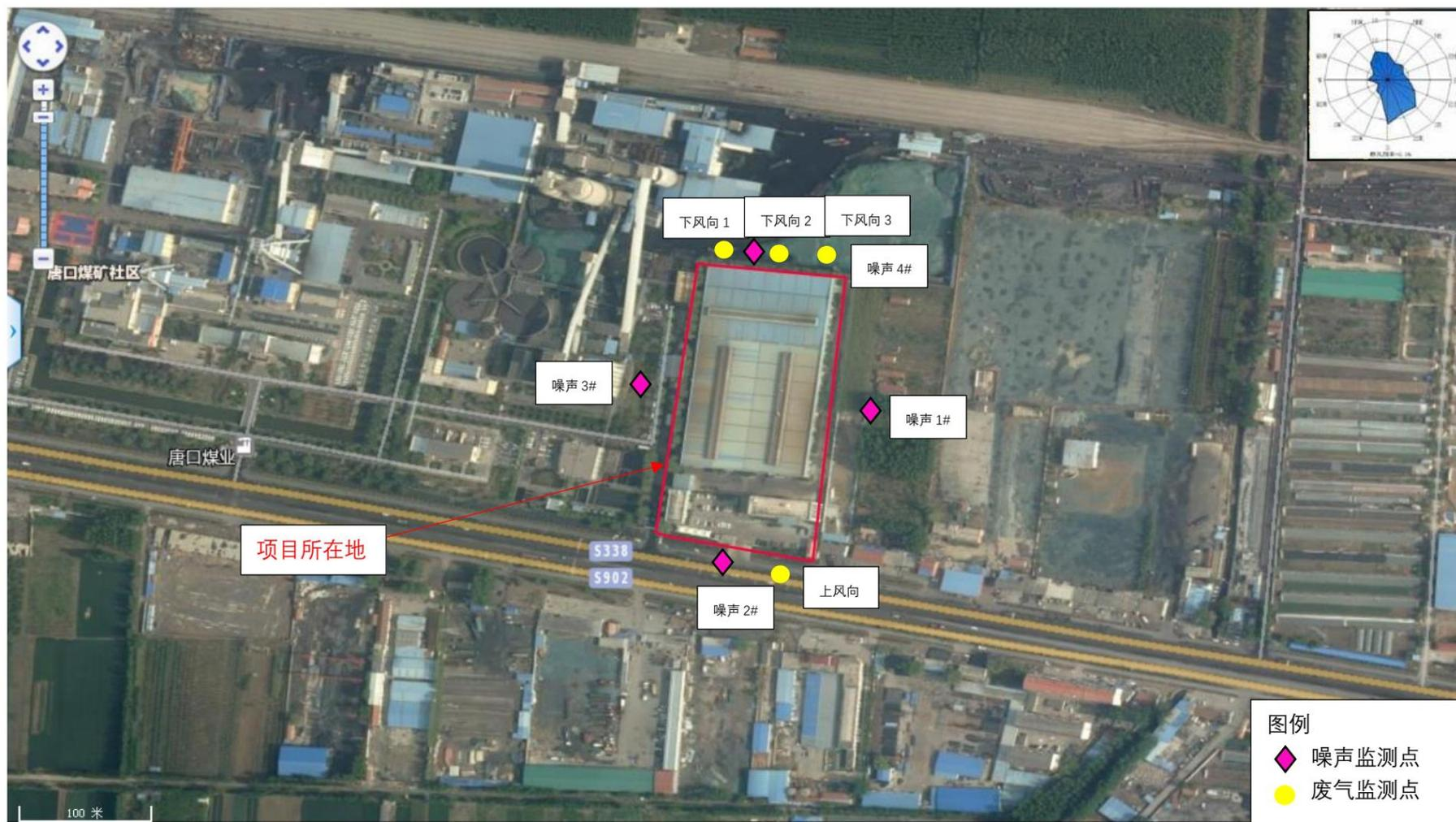
图3.1-7 无组织监测位点布设图
